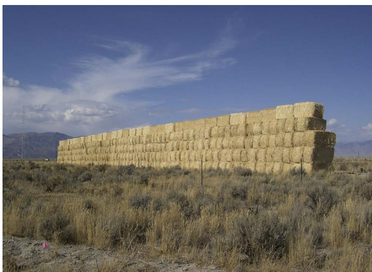
Figur 22. Halmbalar som bullerskärm i en spårgasstudie av Finn et al. (2010).
